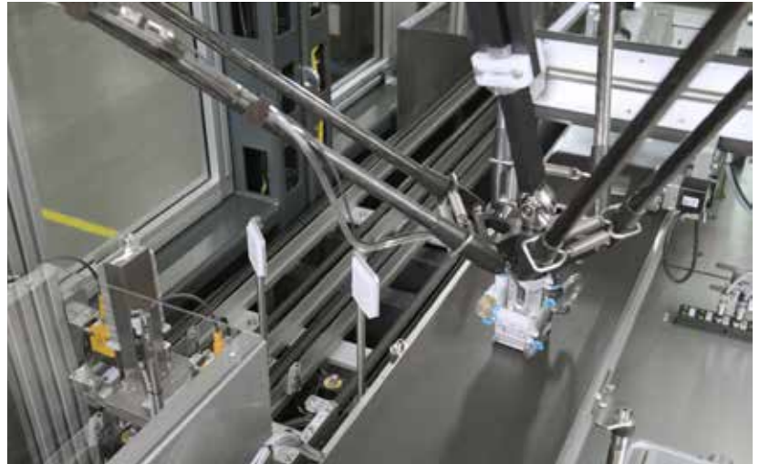
Umsetzen der Bauteile „on the fly“
